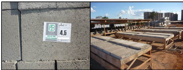
Figura 2 - Blocos de concreto utilizados na construção de complexos residenciais.
